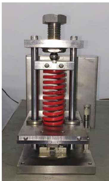
完成 SS304L 不銹鋼試片四點彎曲試驗夾具
