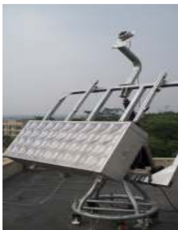
圖 7 (a) 聚光型太陽能模組與追日系統 (b) 測試落塵量的 CMOS 模組
