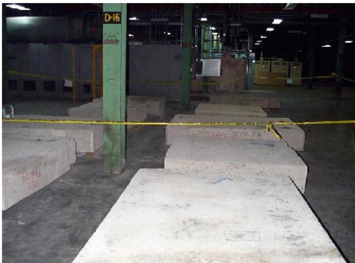
圖 3.5 進行外釋偵檢的混凝土樓板。
