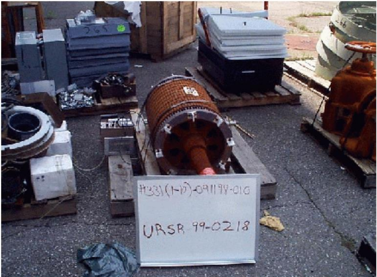
圖 3.10 外釋前可能需要拆卸的馬達轉子。
