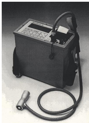
圖 4.1-4 Boltometer 法岩栓灌漿施工品質檢測器
