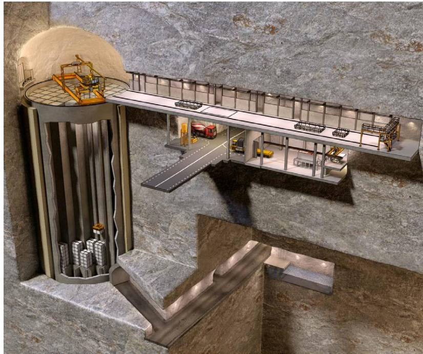
圖2.4-12 運轉期間之筒倉示意圖(SKB, 2014 a,b)
