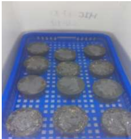
圖 3.6 混凝土浸泡 NaCl 溶液示意圖
