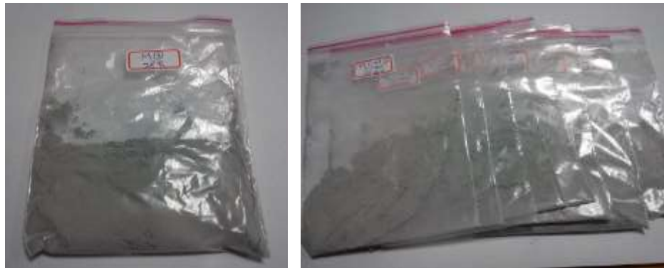
圖 3.8 研磨後的試體與其分層粉末
