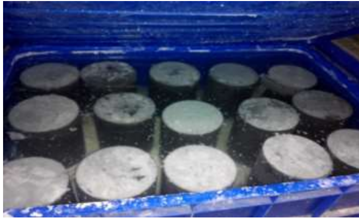
圖 3.4 混凝土浸泡飽和石灰水示意圖
