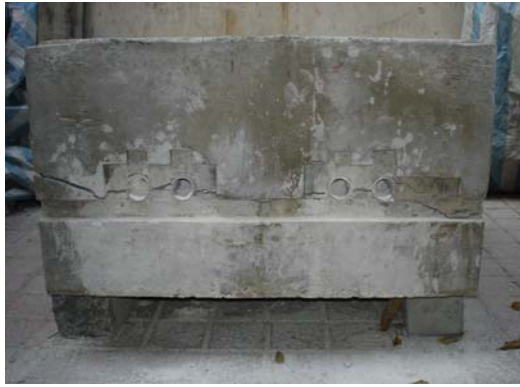
圖 38、試體正面（膨脹水泥反應後）
