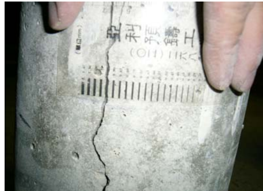
圖 8、產生 1mm 裂縫寬度之圓柱
