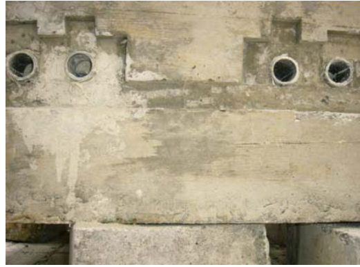
圖 39、試體背面（膨脹水泥反應後， 無裂縫產生）
