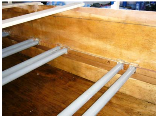
圖 13、預埋塑膠管於混凝土版試體 22.5cm 之深度
