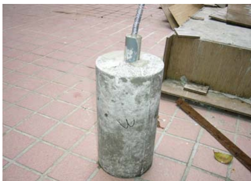
圖 5、膨脹性水泥於塑膠管內
