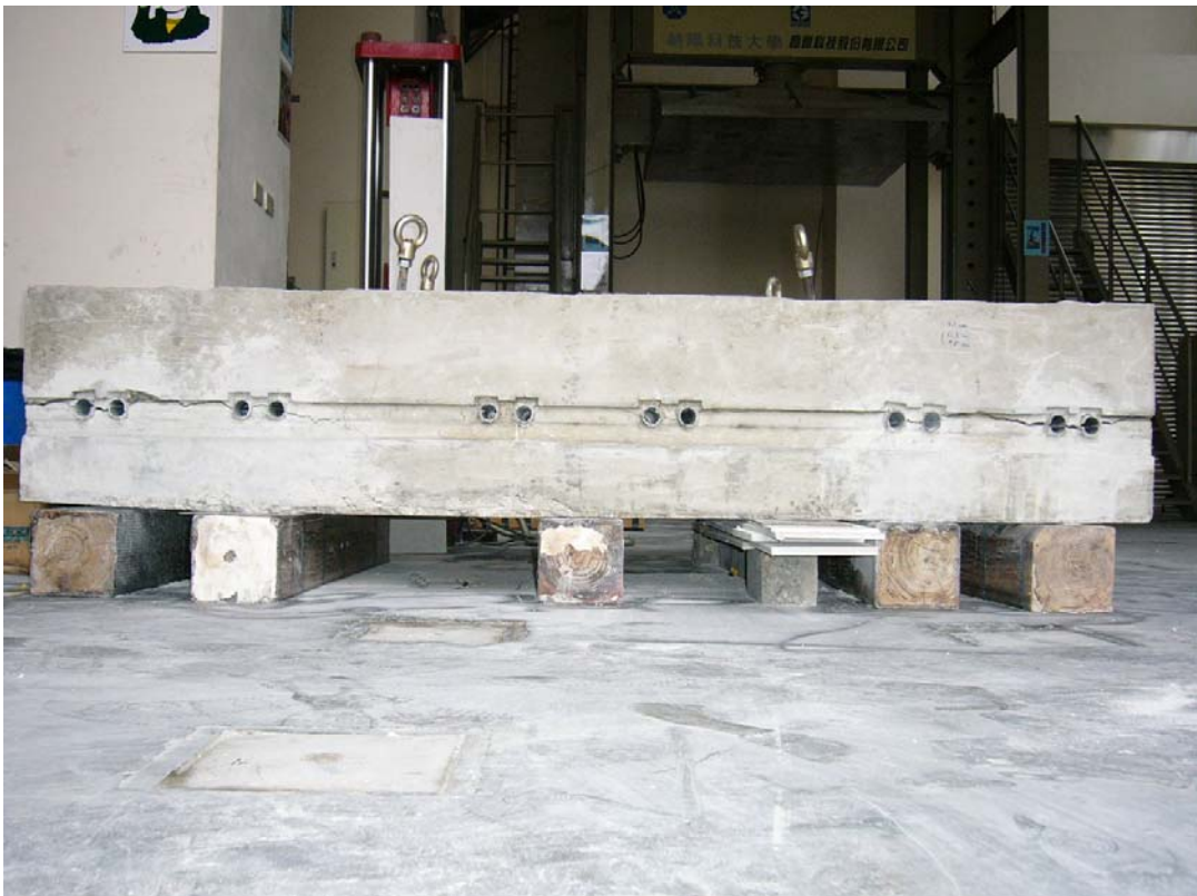
圖 51、僅預埋塑膠管試體開裂之情況(正面)
