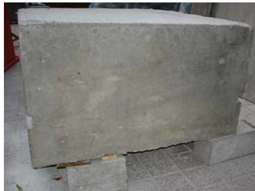
圖 41、試體左側（膨脹水泥反應後）
