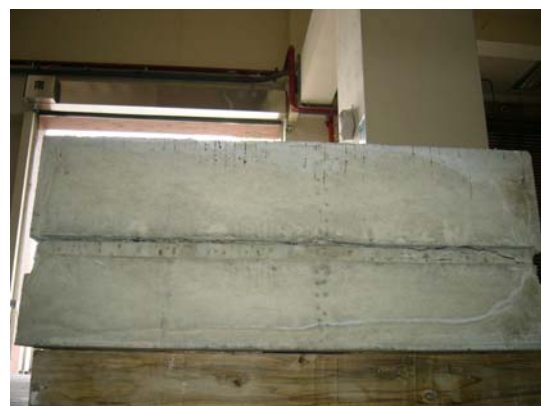
圖 49、預埋鋼筋及塑膠管試體(左側)
