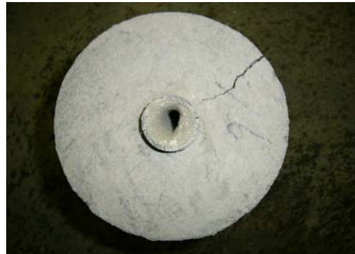
圖 6、產生 1mm 裂縫寬度之圓柱
