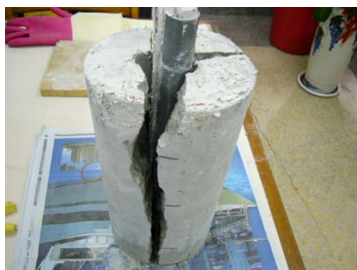
圖 33、裂縫開裂速度過快之圓柱
