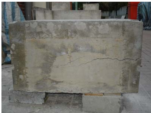
圖 40、試體右側（膨脹水泥反應後）
