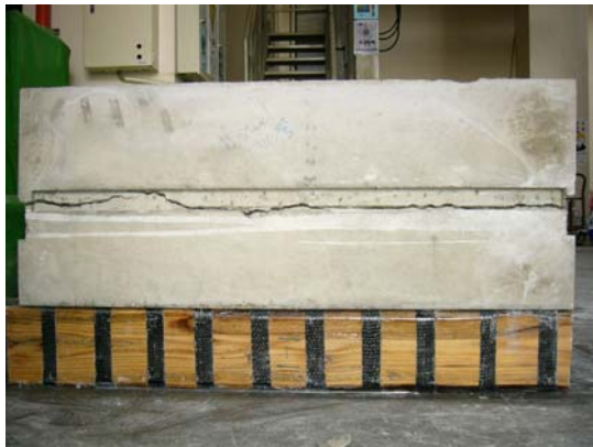
圖 48、預埋鋼筋及塑膠管試體(右側)
