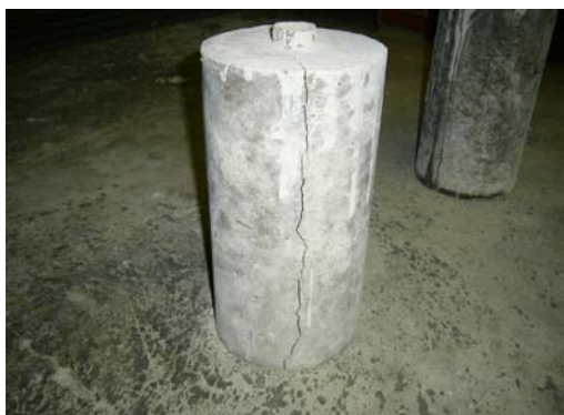
圖 7、產生 1mm 裂縫寬度之圓柱
