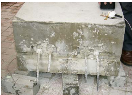
圖 9、試體灌入膨脹水泥後 (正面)
