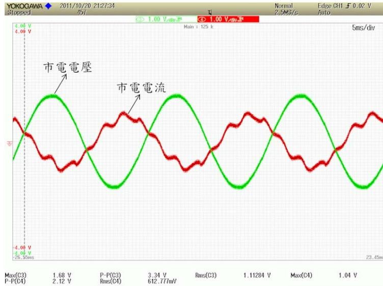
圖 21. 靜態開關導通、市電輸入 2kW
