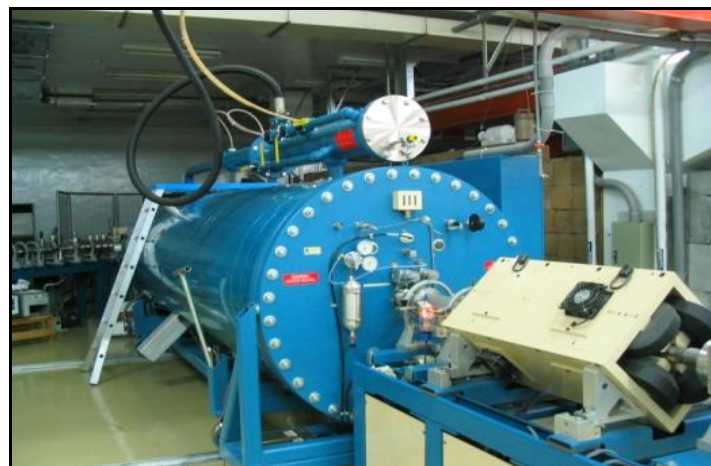
圖 3.4.3.2 串級式加速器(9SDH-2 Tandem Accelerator)
