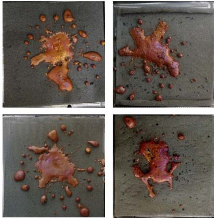
圖 3.4.4.12.重複水溫為 80°C 去離子水的淬冷情況
