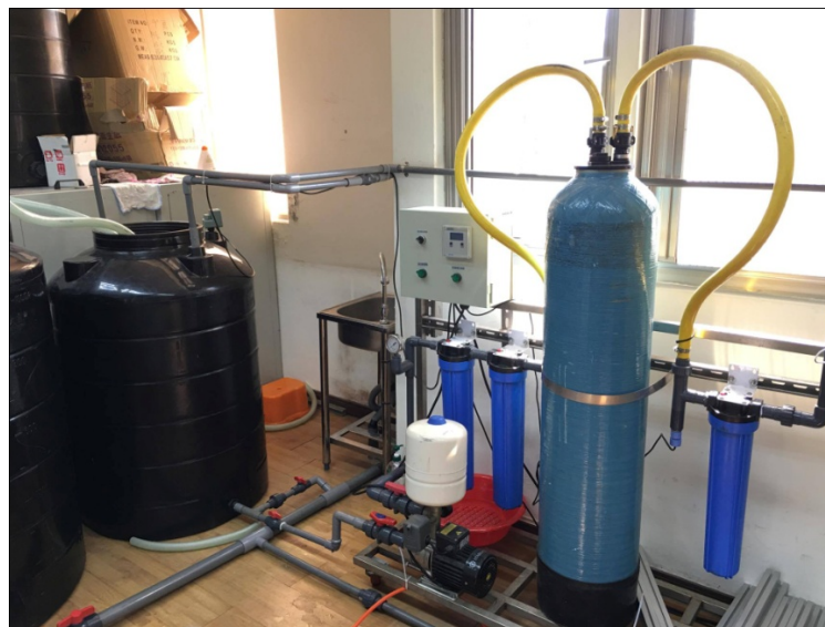
圖 3.1.5.2 實驗迴路純水系統
