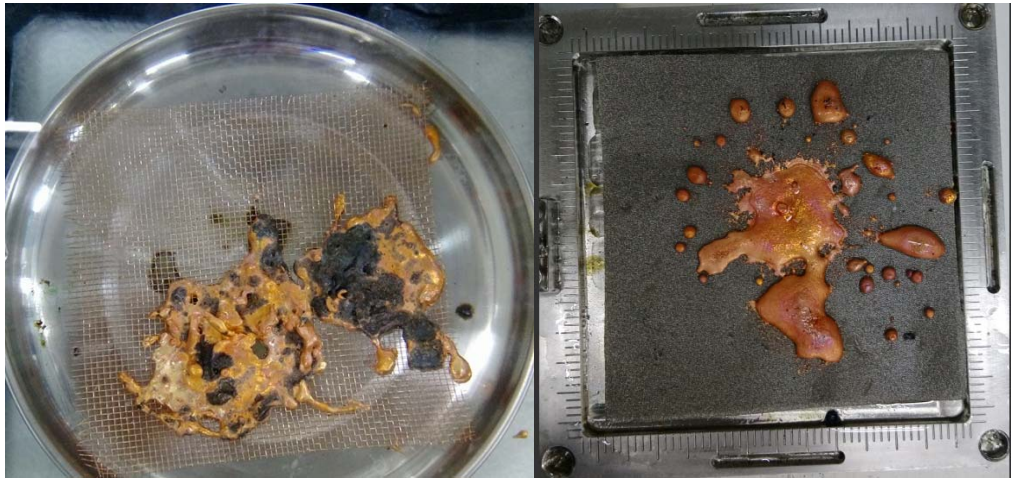
圖 3.4.4.11 高溫熔融銅液於不同水溫的去離子水中淬冷後情況(左圖為水溫為 25°C、右圖為水溫 80°C)
