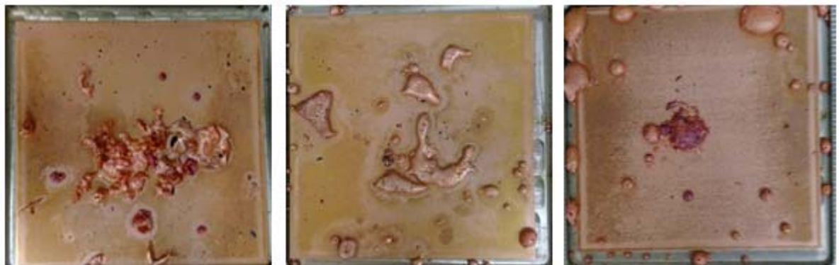
圖 3.4.4.13.高溫熔融銅液於不同溫度海水之淬冷後情況(由左至右溫度分別為 28°C、50°C、80°C)
