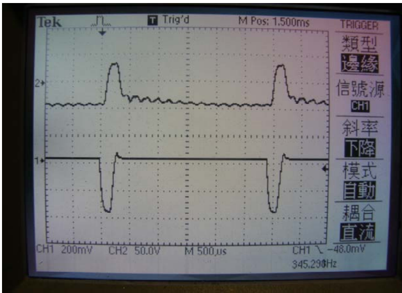
圖十三 相鄰放電間的磁場線圈電流，對儲能電容器上充電電壓的變化
