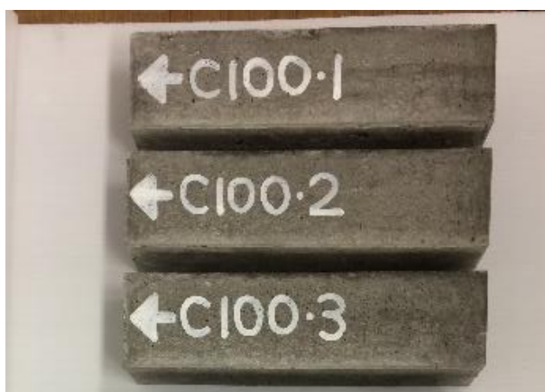
圖 4.52 B200-C100 角柱乾縮試驗前
