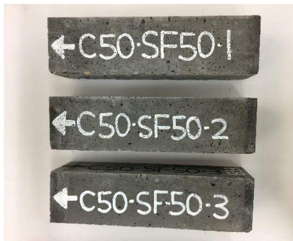
圖 4.54 B200-C50-SF50 角柱乾縮試驗前
