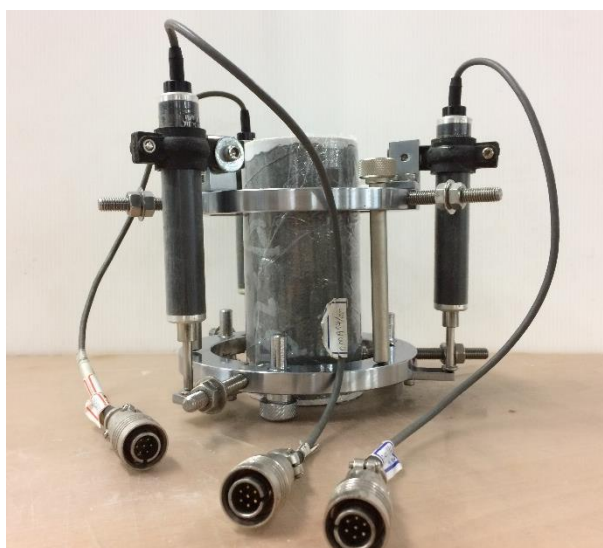
圖 3.17 變位計與圓柱試體
