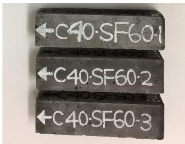
圖 4.55 B200-C40-SF60 角柱乾縮試驗前
