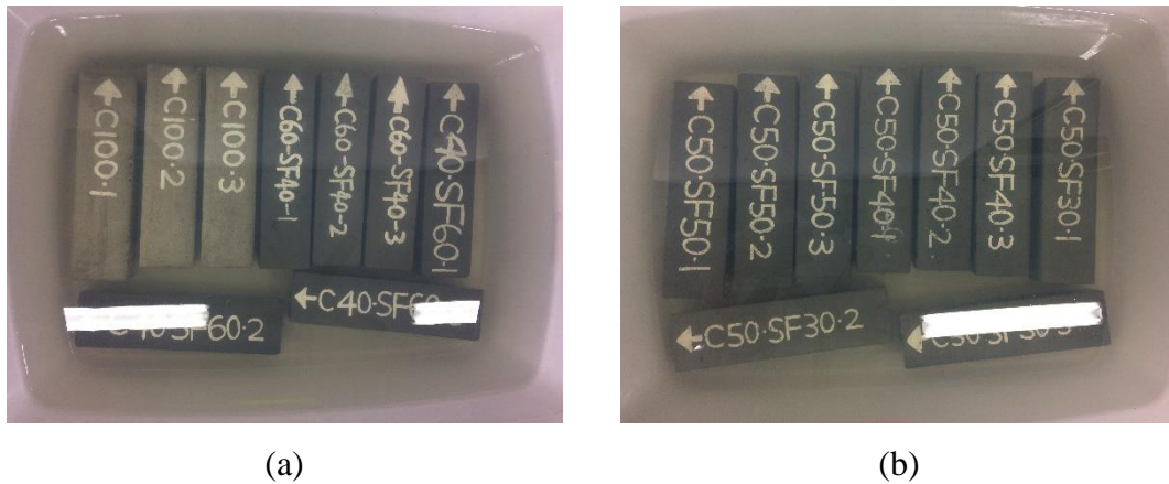
圖 4.57 B200 系列角柱硫酸鹽試體(a)、(b)
