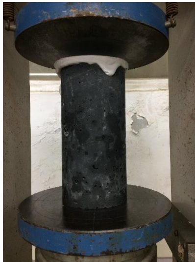
圖 3.21 混凝土抗壓試體
