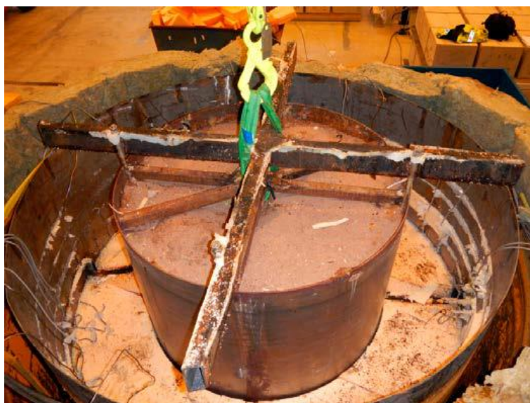
圖 2.22 加熱器在實驗容器中
