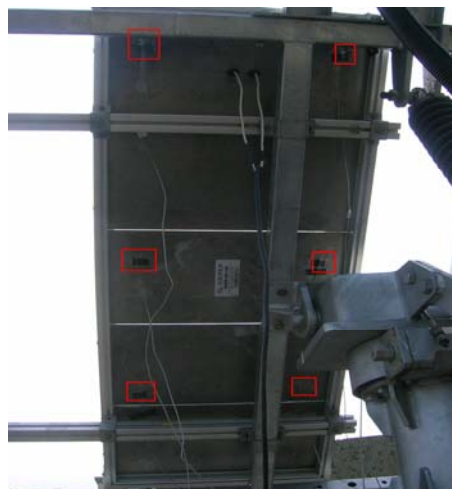
圖 4、HCPV 背板溫度量測點
