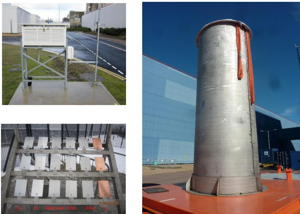
圖 2-6 現地腐蝕監測與試驗密封鋼桶 [2-15]
