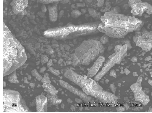
(B) 4M NaOH、0.5wt.% 磷酸二氫鋁、萃取 6 小時
