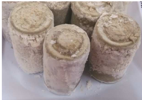
圖 18 岩棉萃製為無機聚合物之外觀圖(4M NaOH、萃製時間 6 小時、 養護天數第 14 天)
