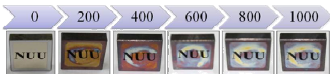
圖 3-6 (Ti,Ta)N/TiN/Ti 多層膜試片經過熱反覆與熱壓鑄實驗後之試片表面狀況
