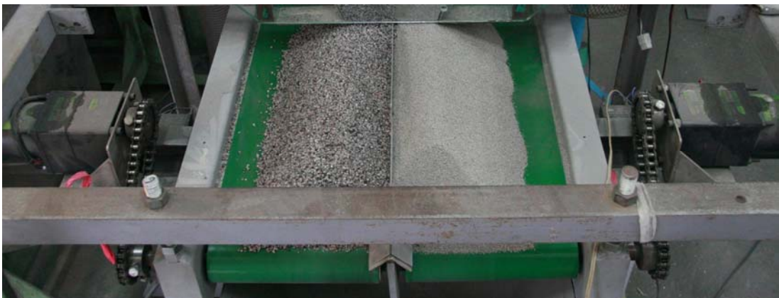
圖 6 二維流動式顆粒床實際設備圖
