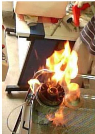
圖 3-16. 燃氣供應量  $0.5 \text{ kg/cm}^2$  點火測試(點火器靠近燃氣出口)
