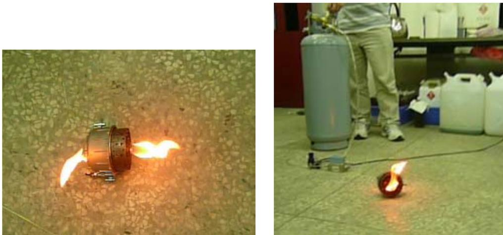
圖 3-14. 燃燒筒點火測試結果
