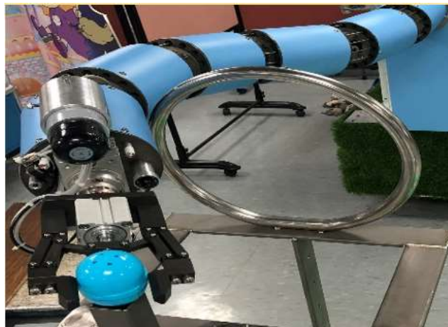
圖 28 核研所蛇形機器手臂轉彎避開障礙物測試實景
