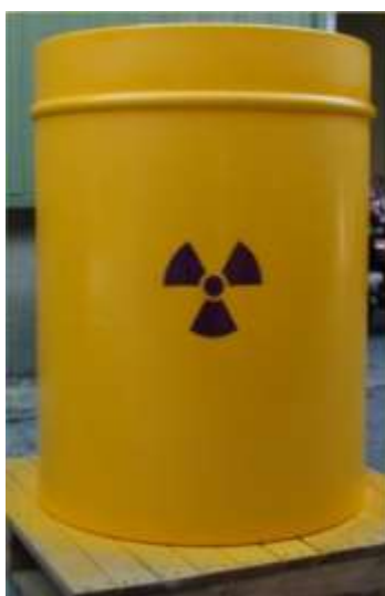
圖 25 核研所研發可維持一百年結構完整之高性能混凝土處置容器
