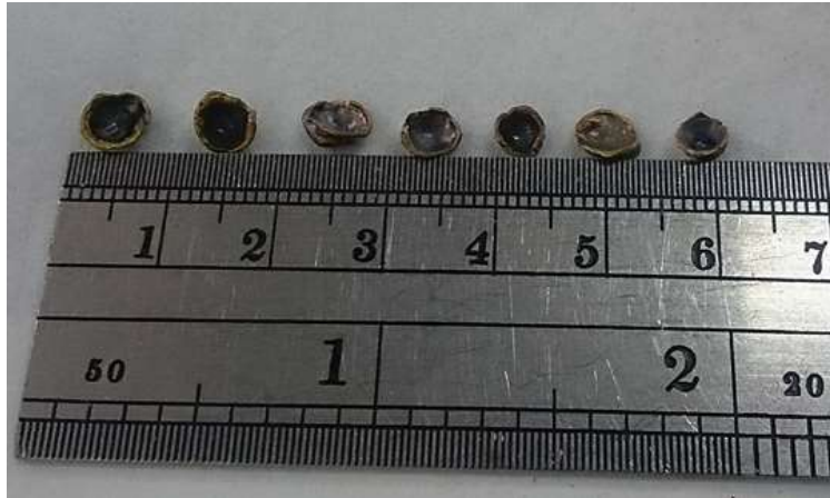
圖 3.4.2.27 淬冷凝固後之銅磷合金粒
