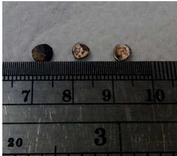
圖 3.4.2.33 3 組凝固熔滴金屬之尺寸對照，由左至右依序為實驗 1、2、3
