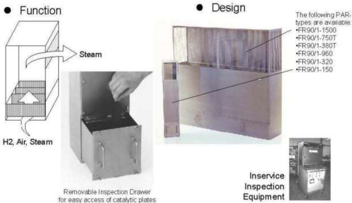
圖 3.2.66 被動式氫氣再結合器的設計與功能
