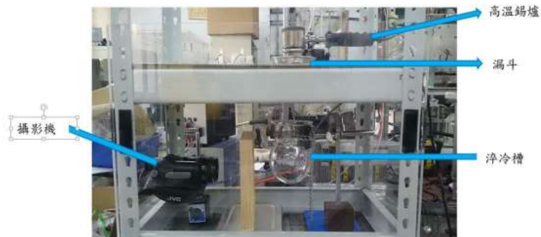
圖 3.4.2.25 熔融鹽淬冷實驗架設圖
