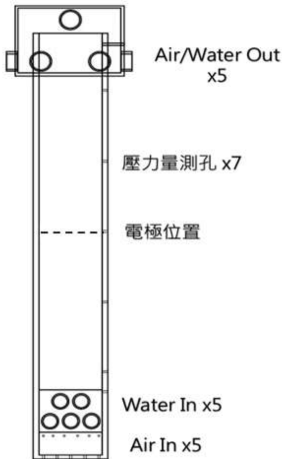
圖 3.1.2.6 單一通道汽液雙相流實驗段
