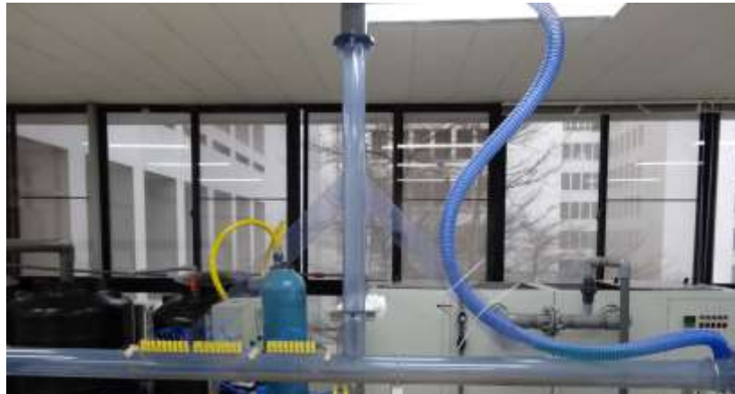
圖 3.1.5.3 T 型管實驗模組
