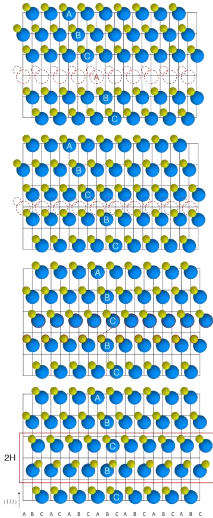
圖 3.4.3.14 內置型疊差環形成流程圖
