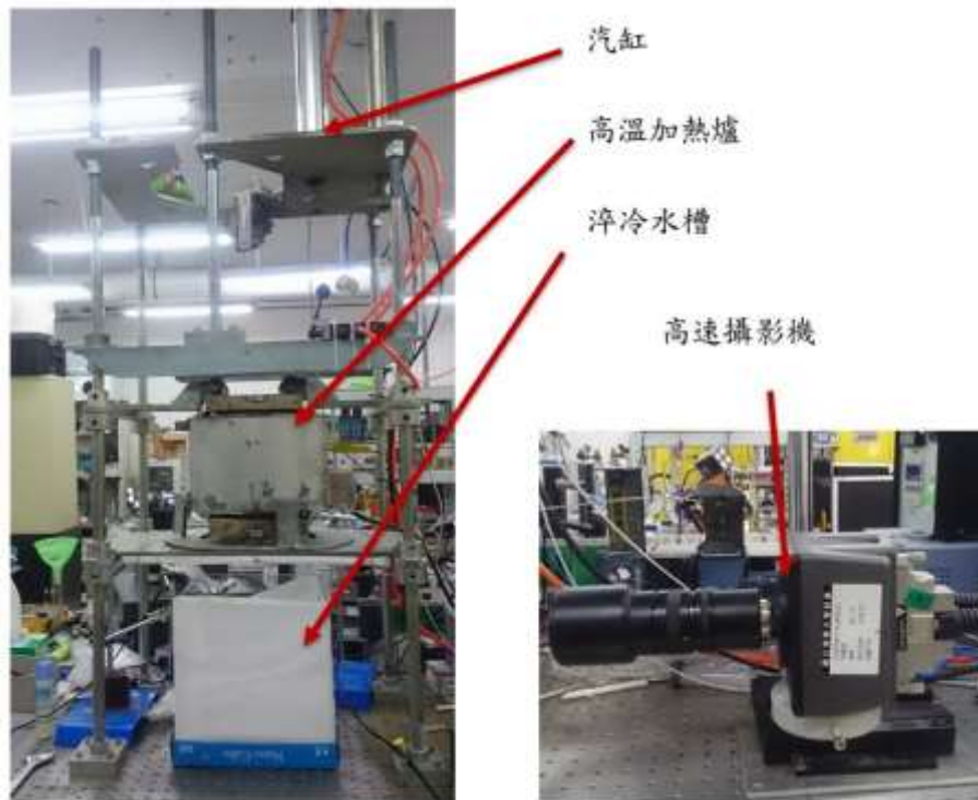
圖 3.4.2.35 高溫熔融物質實驗架設
