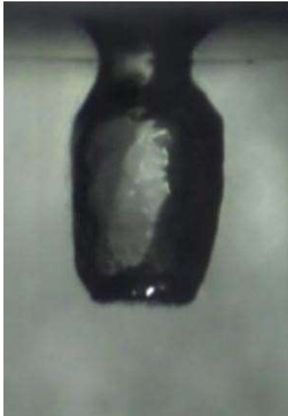
圖 3.4.2.32 由高速攝影機擷取之 3 組金屬熔滴淬冷過程
