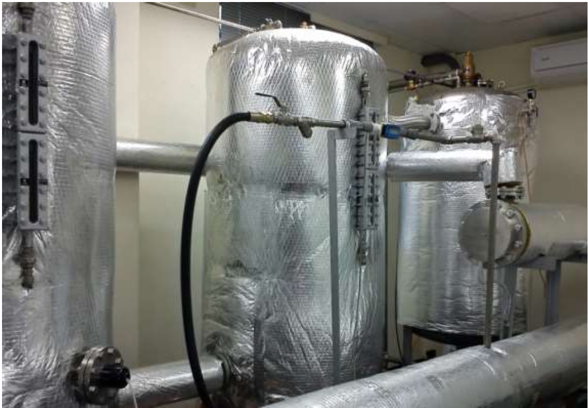
圖 3.4.2.3 實驗用封閉式加熱壓力水槽
