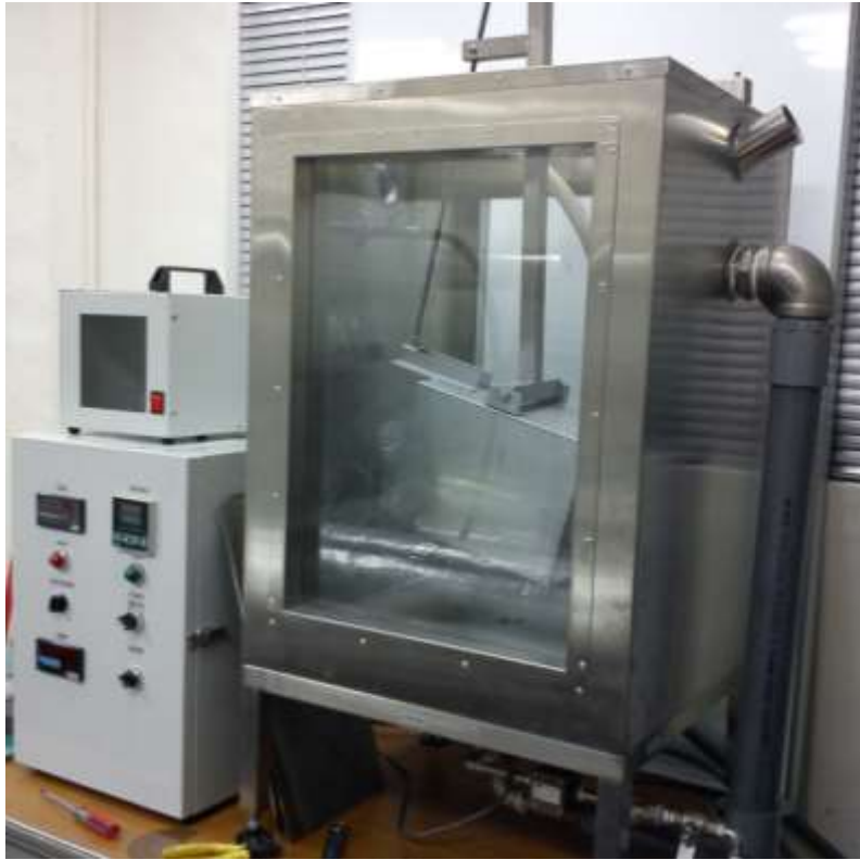
圖 3.4.2.4 實驗水槽及加熱模組環路裝置圖
