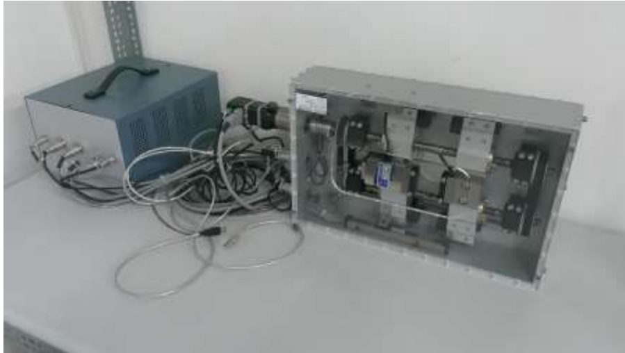
圖 3.4.3.74 完成之拉伸機實際照片
