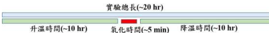
圖 3.4.3.18 高溫爐實驗時間流程圖
