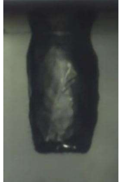
圖 3.4.2.32 由高速攝影機擷取之 3 組金屬熔滴淬冷過程
