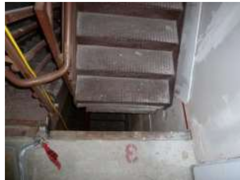
圖 4 BNCS 實驗結果，樓梯於地震後斷裂情形
