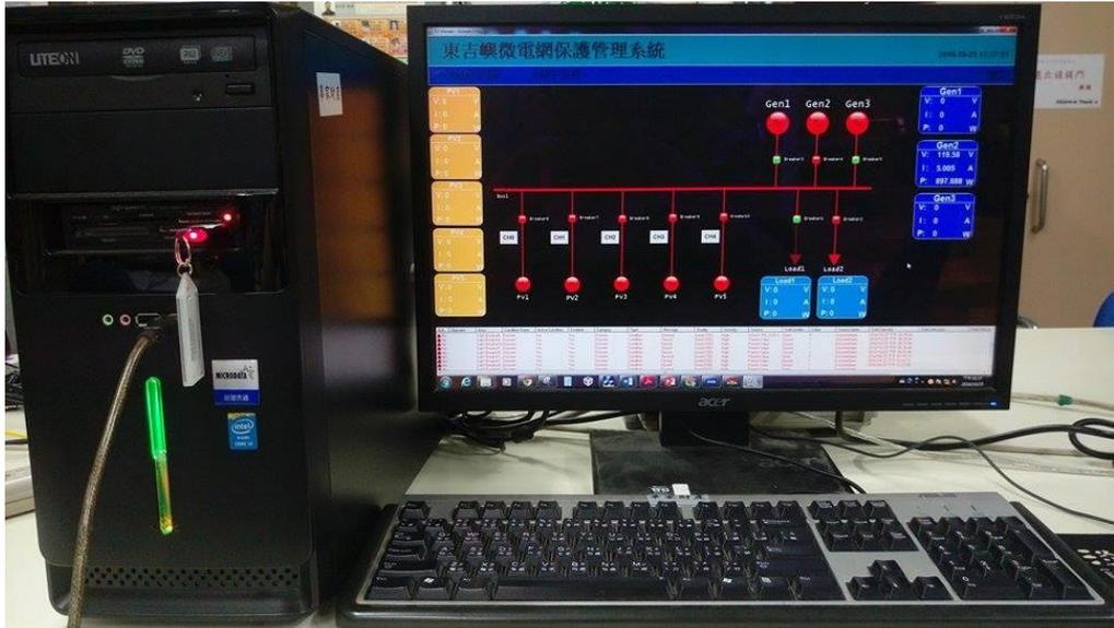
圖 6-13 Elipse Power SCADA 暨保護管理系統
