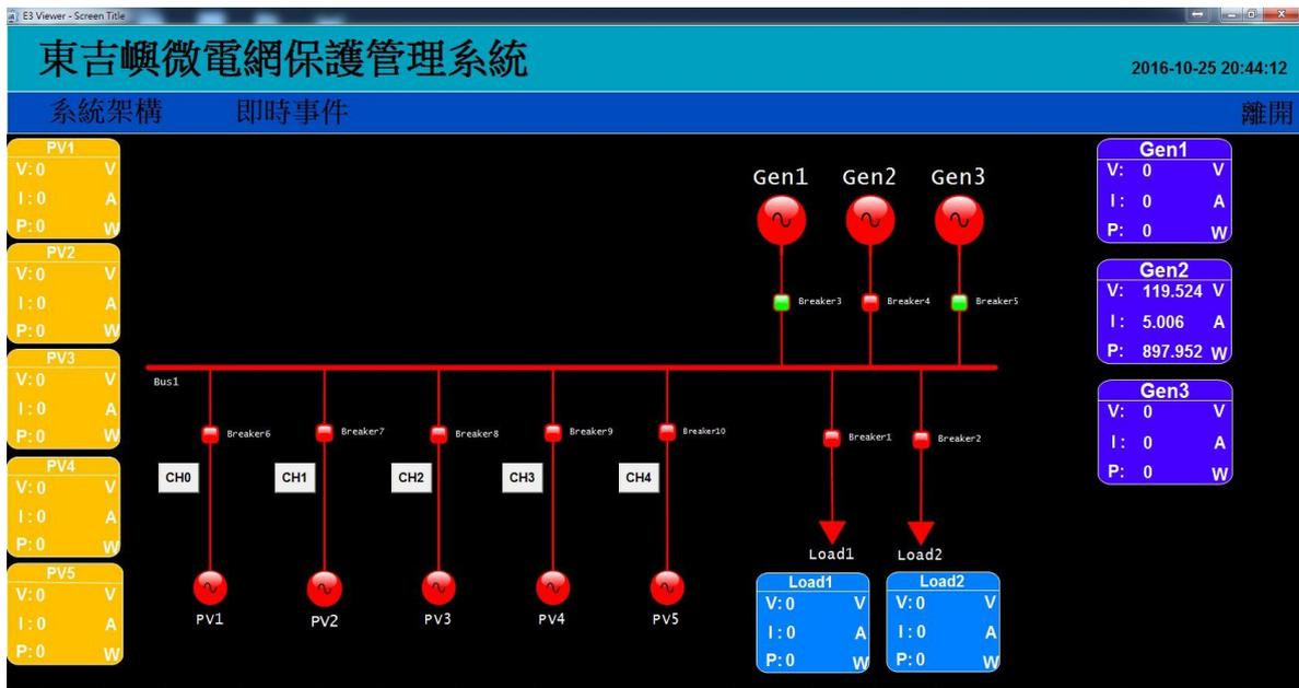
圖 6-16 SCADA 正常運作畫面
