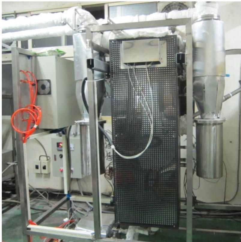
圖 2.2 20 kWth 內通式流體化床氣化爐實體構造
