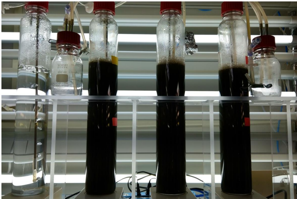
圖一、1L 光反應器-微藻培養裝置
