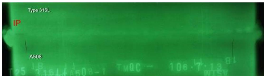
圖 A.1 加工圖 2.15 之銲接件的 RT 檢測照片。
