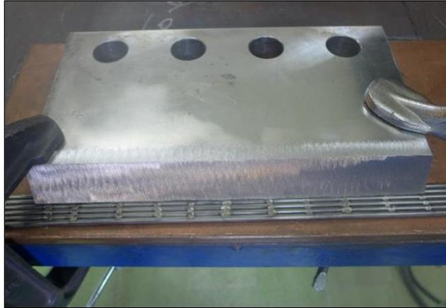
圖 2.7 A508 開槽尖端下方置放 IN 182 鋅條襯板。
