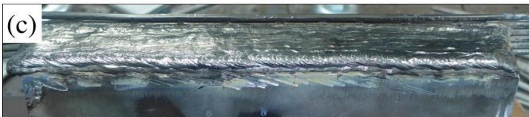
圖 2.8 A508 開槽端表面施作 IN 182 之(a) 第 1 層、(b) 第 2 層及(c) 第 3 層緩衝層的外觀照。
