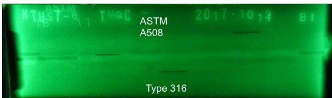
圖 A.2 加工圖 2.16 之銲接件的 RT 檢測照片。
