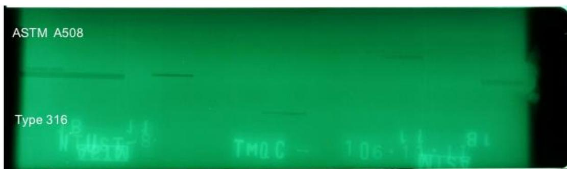
圖 A.3 加工圖 2.16 之覆銲件的 RT 檢測照片。
