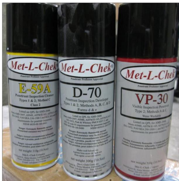
圖 2.14 液滲檢測使用之 E-59A (清潔劑)、VP-30 (色比式滲透液)、D-70 (顯像劑) 之外觀照。
