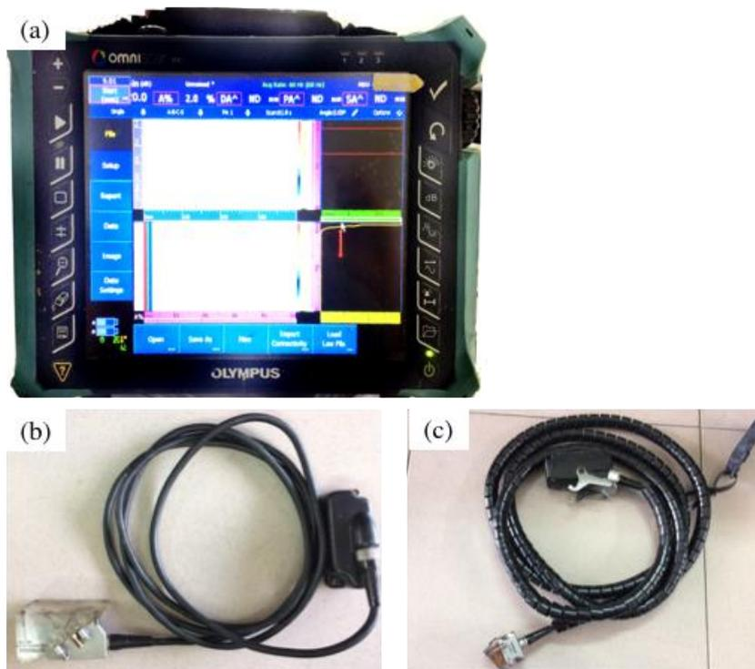
圖 2.18 (a) 超音波量測儀、(b) 單晶探頭及(c) 雙晶探頭之外觀照。
