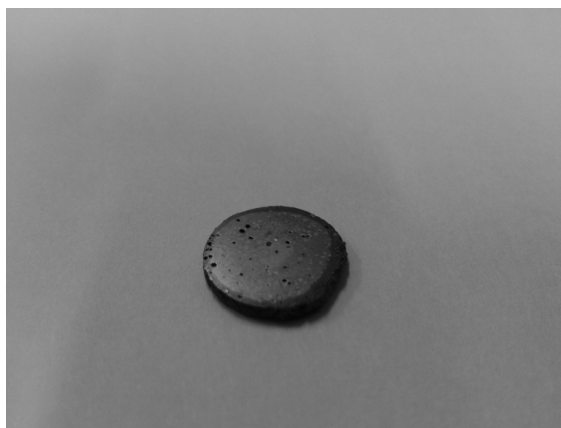
圖 9 ss430-Cu 雙層粉 20%(<500um)+ss430 細粉以 5000kg/cm 2 壓胚
