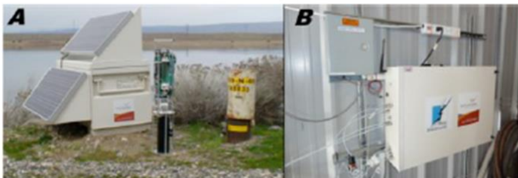
圖 5-8 用於偵測地下水中 ^{90}\text{Sr} 、 ^{99}\text{Tc} 含量的原型機示意圖
