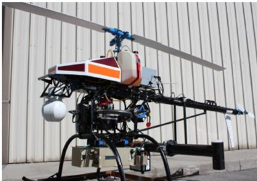
圖 5-7 B1-100 直升機型無人飛行器平台示意圖
