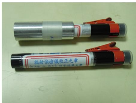
圖 3.3 有加鋁套筒(上)與未加鋁套筒(下)之劑量筆
