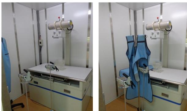
圖3.7 考量動物用X光檢查儀協助者在檢查室內協助動物擺位照相的情形，以手持式偵檢器測量，評估其有穿(右)及無穿(右)鉛屏蔽衣之居佔位置劑量(率)示意圖
