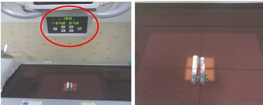
圖 3.5 劑量筆放置於 X 光管正下方測試有效濾片厚度
