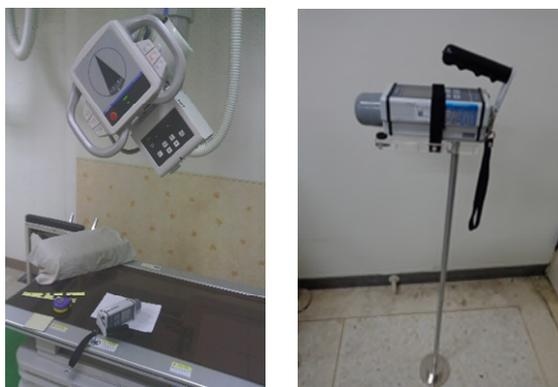
圖 3.1 輻射偵檢器(AT-1121)放置於 X 光管正下方距靶一公尺處檢測滲漏輻射(左)，以及自製可伸縮高度之偵檢器支架(右)
