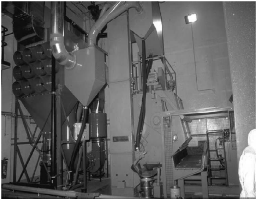
圖 3-10 使用乾式噴砂於小型混凝土容器[11]
