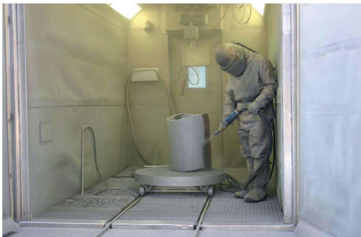
圖 3-4 研磨料為砂之噴砂除汙作業方式[15]
