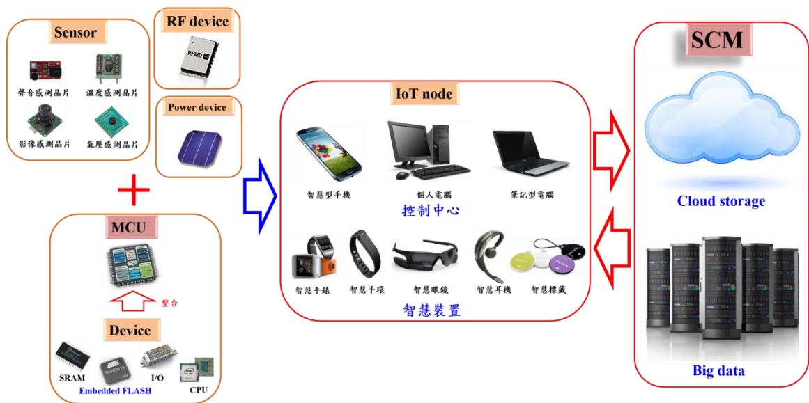
圖 9. IoT 的架構中包含了雲端存儲(Cloud)、資料分析(Big data)與末端的節點裝置 (node)
