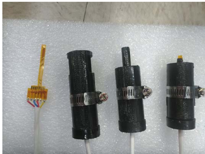
圖四十一 感測器外殼封裝成品
