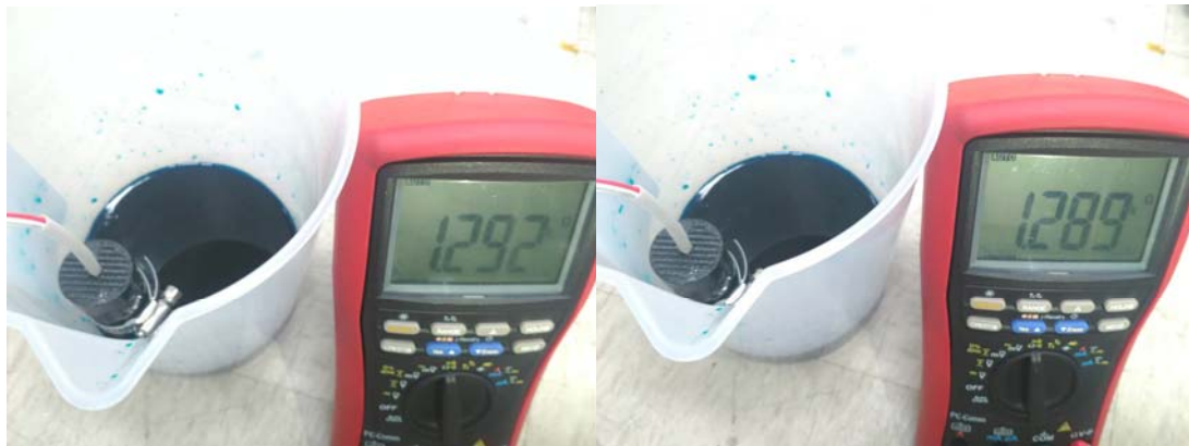
圖四十九 三用電錶量測可撓式微感測器之電阻值照片
