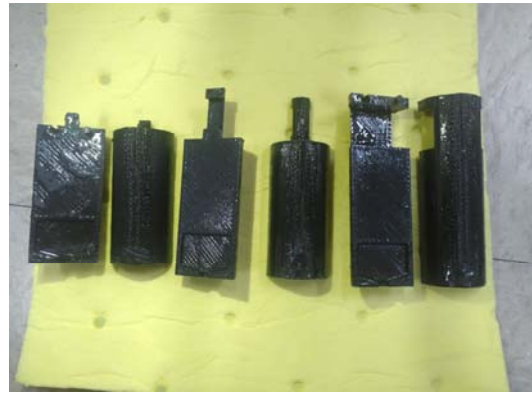
完成浸泡的感測器外殼
