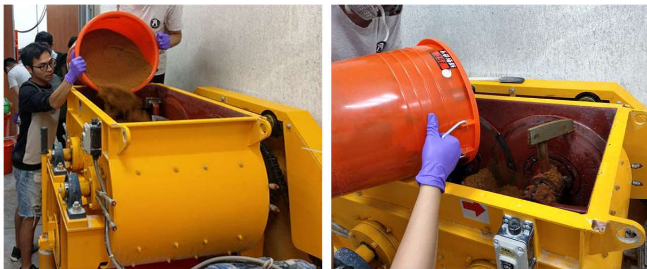
圖 3-1 添加模擬核種之大型試驗製作情形
