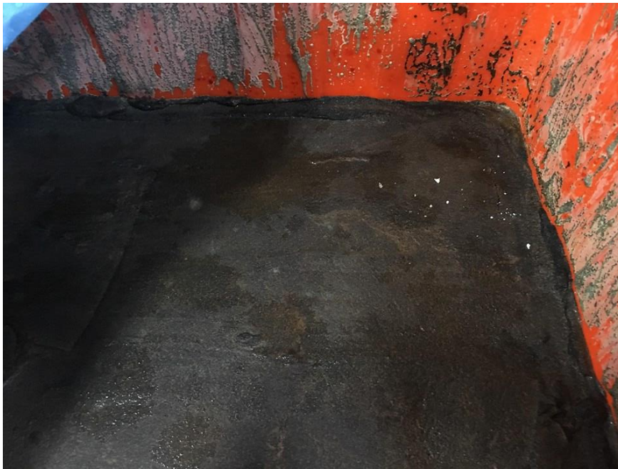
圖 3-3 R41-K5 系列(大型試驗)大型固化體自由水(28 天) (樹脂添加量為 41wt.%，高錳酸鉀粉體添加量為 5 wt.%，鹼液濃度 為 12 M、 \text{SiO}_2/\text{Na}_2\text{O} 為 0.8、 \text{SiO}_2/\text{Al}_2\text{O}_3 為 50)
