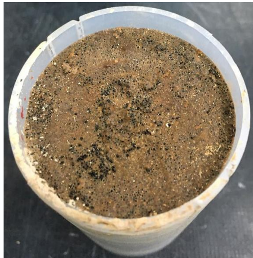
圖 3-2 R41-K5 系列(大型試驗) \Phi 5 \times 10 cm 圓柱固化體自由水(28 天) (樹脂添加量為 41wt.%, 高錳酸鉀粉體添加量為 5 wt.%, 鹼液濃度為 12 M、 \text{SiO}_2/\text{Na}_2\text{O} 為 0.8、 \text{SiO}_2/\text{Al}_2\text{O}_3 為 50)
