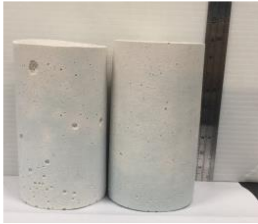
圖 3-17 改善測試方法後經耐候性試驗後之固化體
