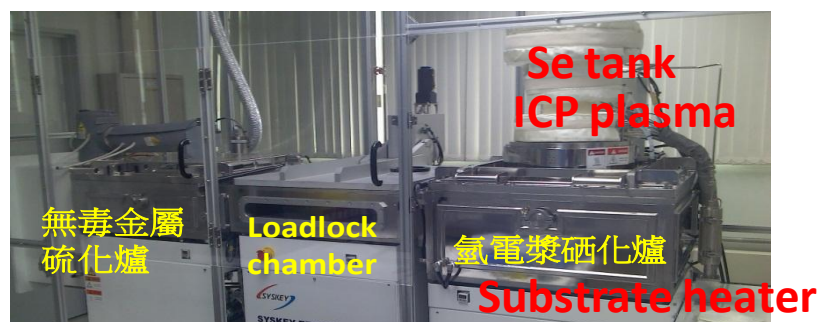
圖 2: 大面積( G1\ 30X40cm^2 )連續式濺鍍系統及氬電漿硒化/無毒金屬 硫化設備
