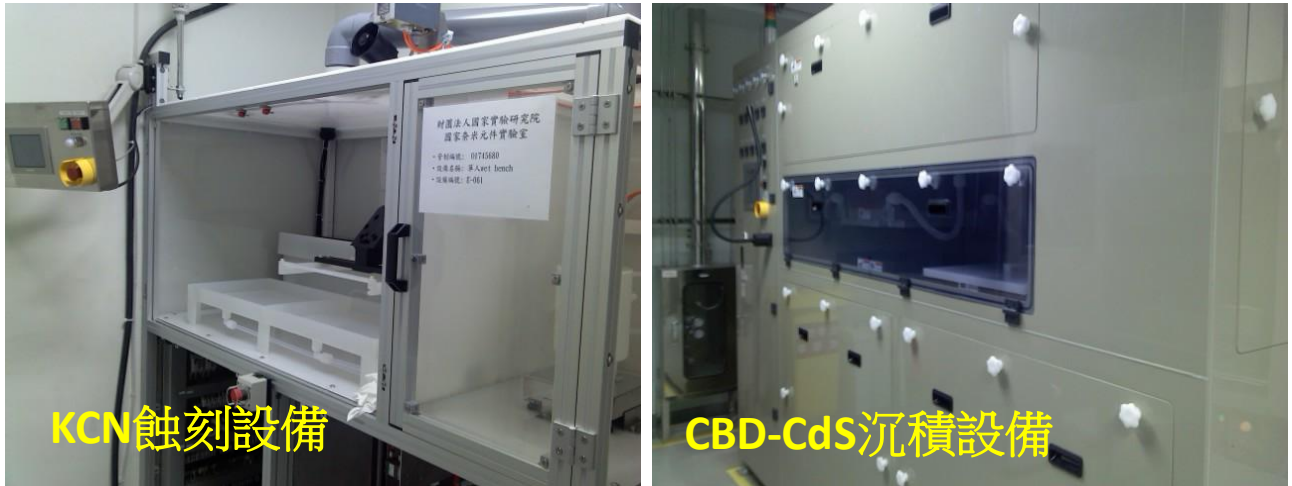
圖 3：大面積(G1 30X40cm 2 )化學清洗製程設備(KCN & CdS)
