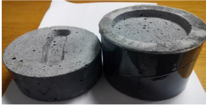
圖 3.9 研磨後的試體與其分層粉末分析階段
