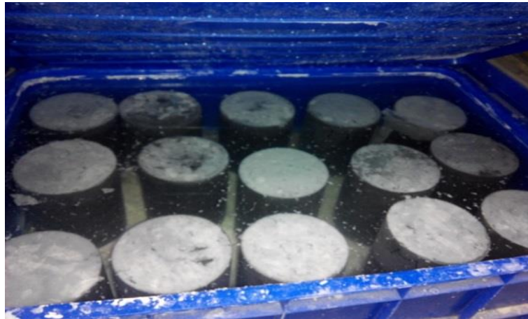
圖 3.4 混凝土浸泡飽和石灰水示意圖
