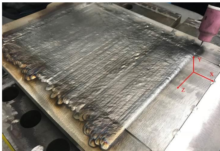
圖2.11 覆鋅工法示意圖。
