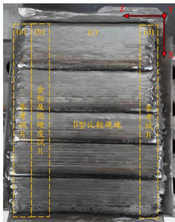
圖2.14 試片取樣示意圖
