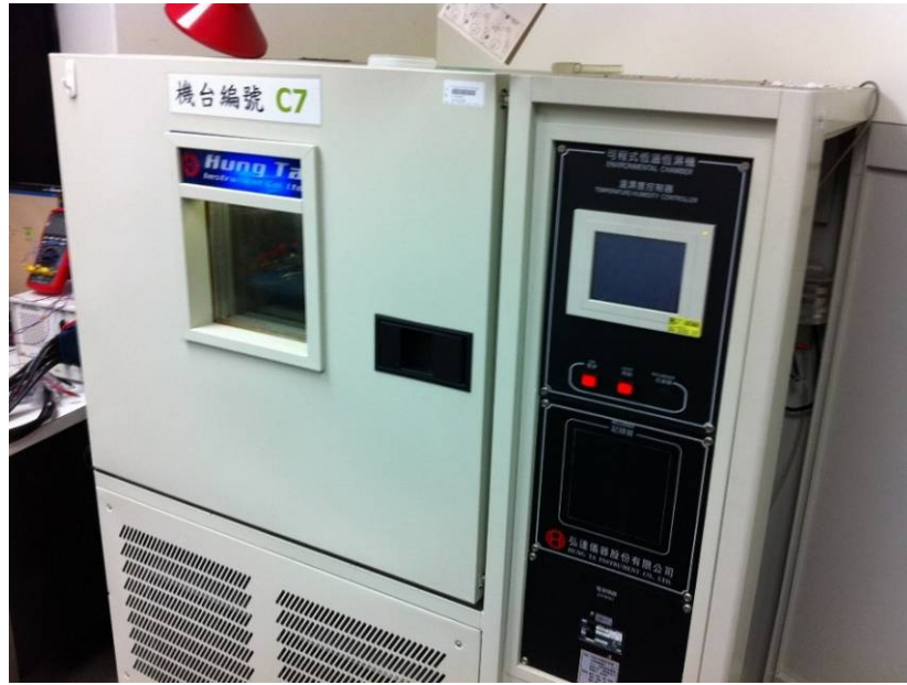
圖2.11 可程式控制恆溫恆濕試驗機 (Hung ta HT-8045A Environmental Chamber)
