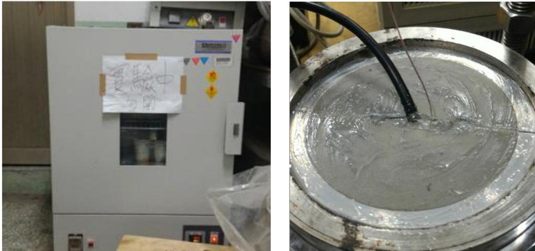
(A)  $90^{\circ}\text{C}$  定溫烘箱；(B) 試體配置圖
