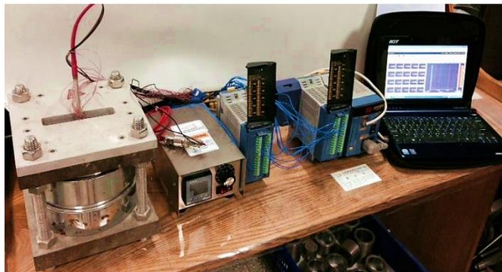
圖 3.7 溫度分佈量測系統
