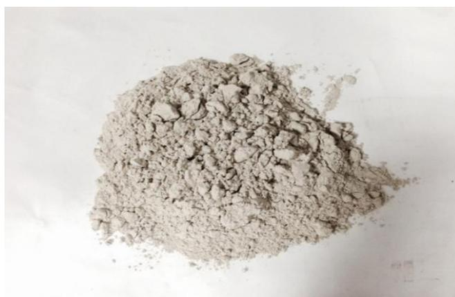
圖 3.1 試驗所使用 SPV 200 膨潤土(自然含水狀態)
