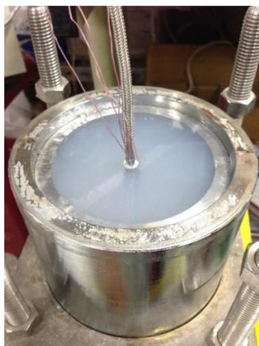
圖 3.12 熱探針校正狀態
