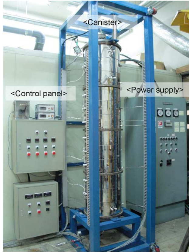
圖 9、YOO 等人[5]利用縮尺模型進行燃料束自然循環實驗
