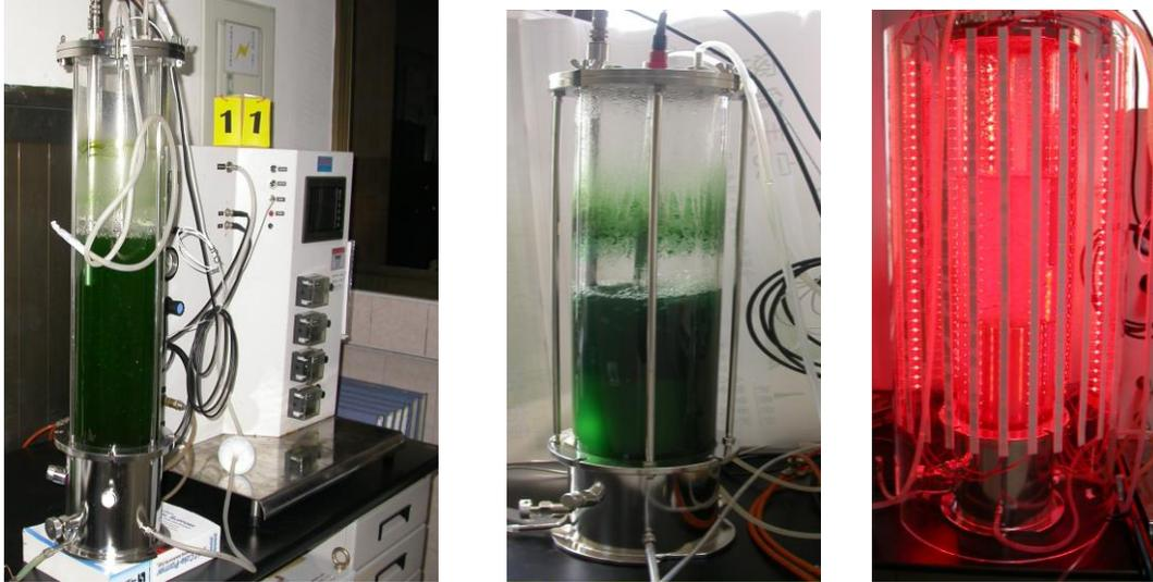
圖二十九、氣舉式光反應器與微藻專用的新式氣舉光罩系統
