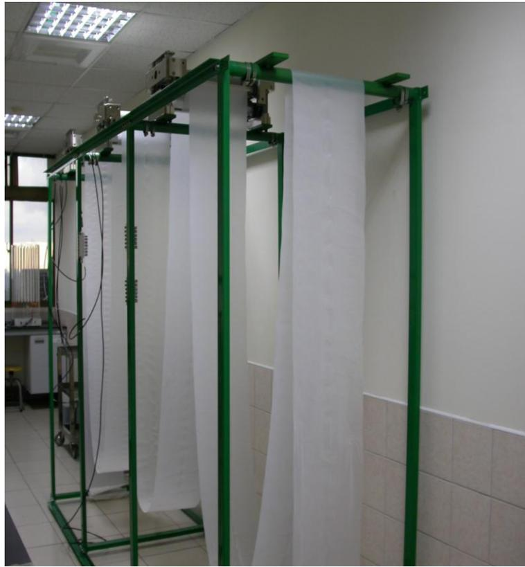
圖三十、V 型管光反應器系統
