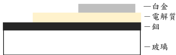
圖 2.5 玻璃/鉬/鋰錫氧硫薄膜/白金之 MIM 示意圖
