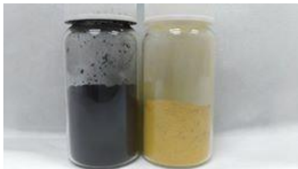
圖 3.1 左為前驅粉體，右為鋰錫氧硫固態電解質粉體
