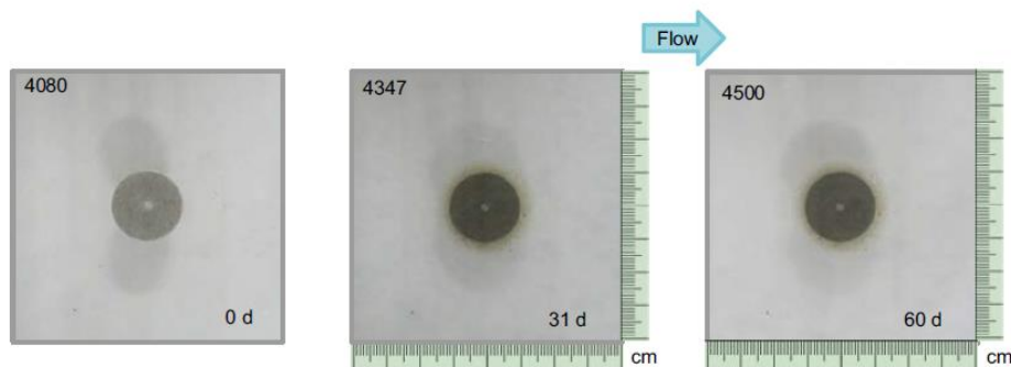
圖 2-10 MX-80 膨潤土沖蝕實驗之回脹歷程 (SKB, 2019)
