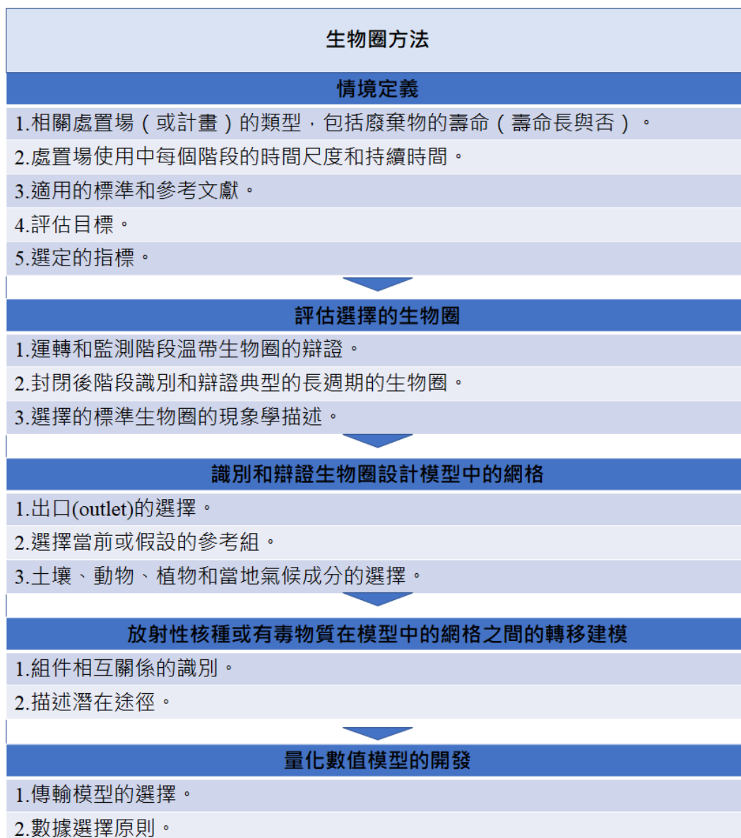
圖 3-16 顯示選擇和描述生物圈的不同階段的圖表(改自 ANDRA(2016a) figure 5.6-4)
