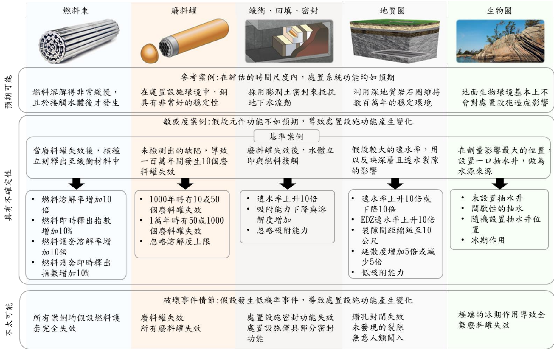
圖 3-19 NWMO 安全評估之正常情節、正常情節敏感度研究與破壞事件情節考量示意圖(改自 NWMO(2017) figure 7-1)
