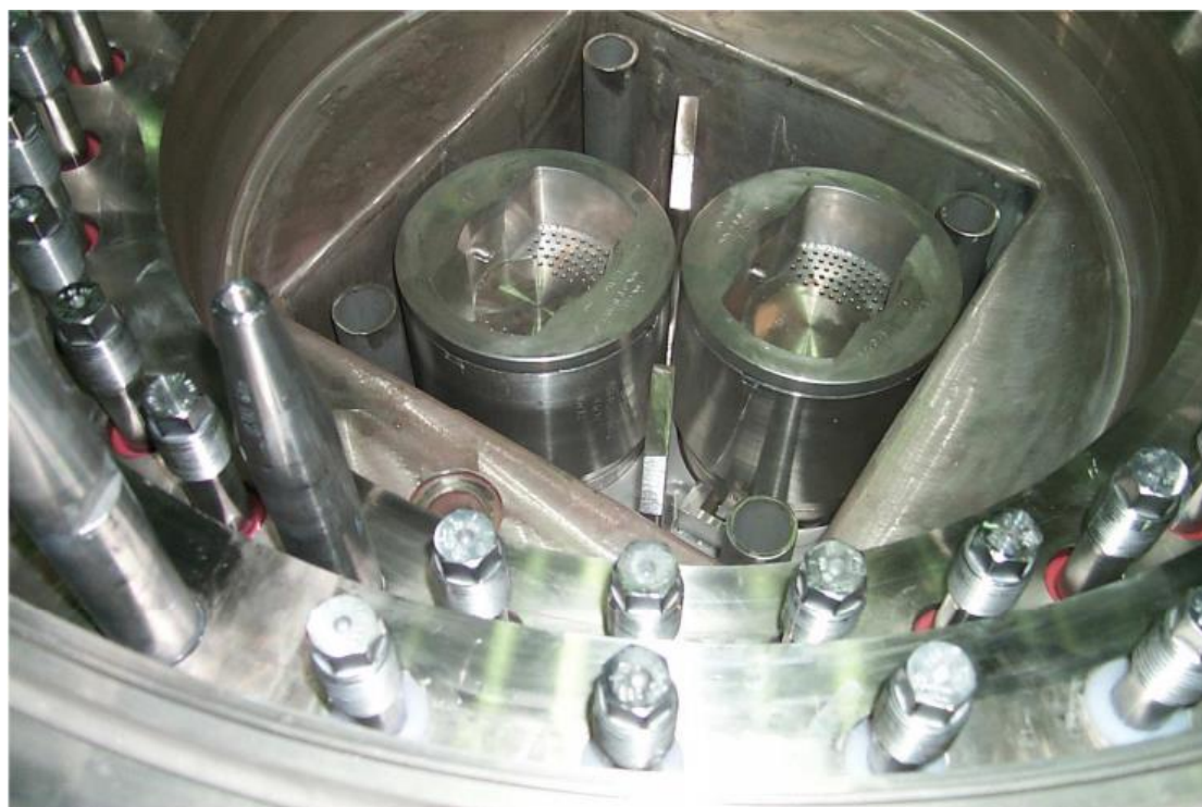
圖 29 裝載完成的 CASTOR KRB-MOX 護箱
