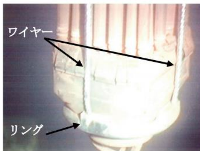
圖 35 加強多根破損燃料棒的燃料組件 [77]
