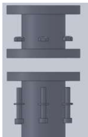
圖 14 測試端爆炸圖
