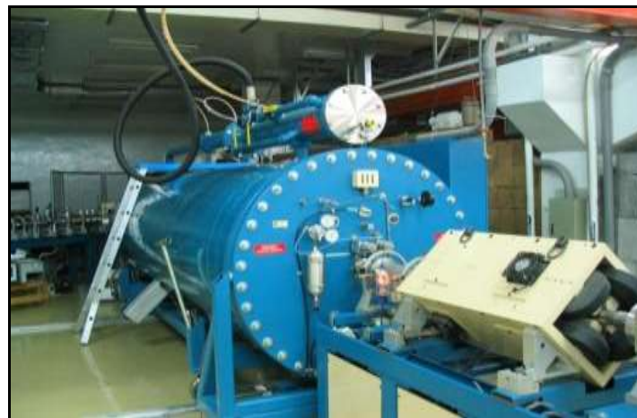
圖 3.4.3.2 串級式加速器(9SDH-2 Tandem Accelerator)
