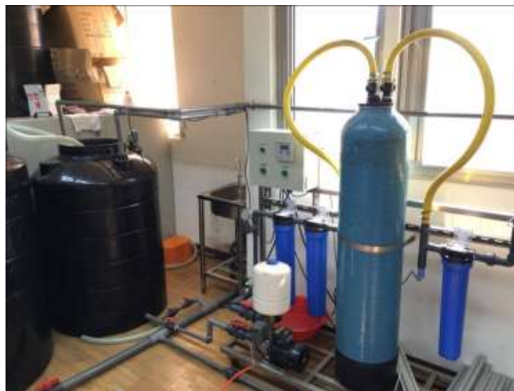
圖 3.1.5.2 實驗迴路純水系統
