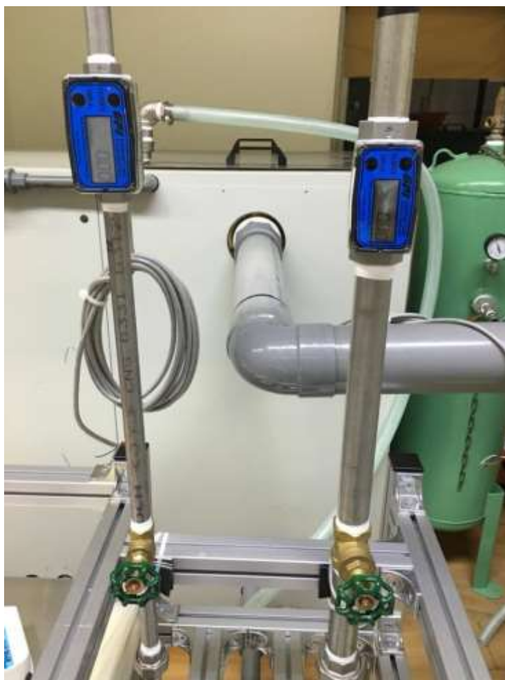
圖 3.1.5.12 電子式液體流量計
