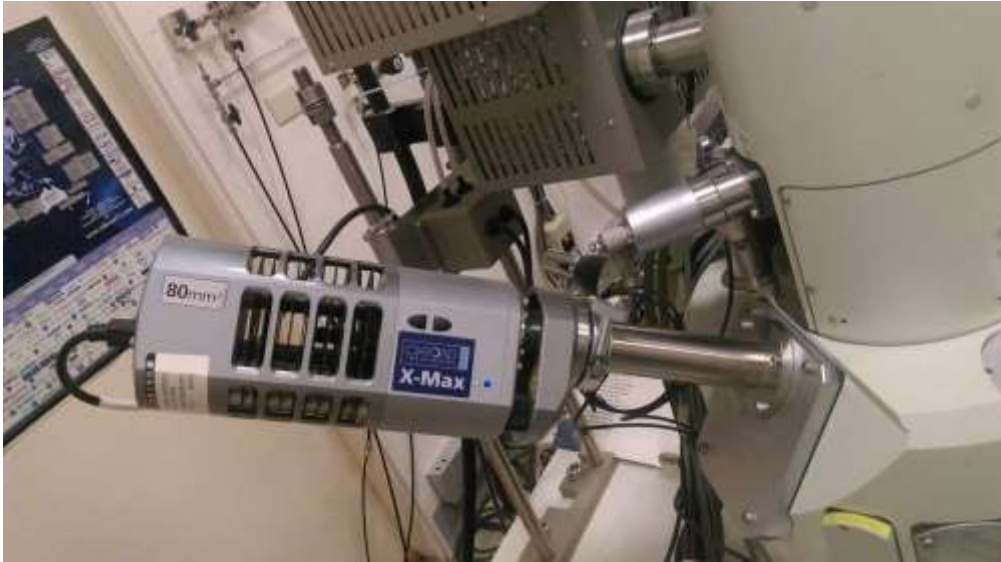
圖 3.4.3.24 配置在掃描電子顯微鏡之能量散布能譜儀
