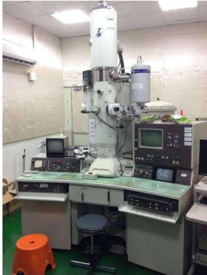
圖 3.4.3.7 JEOL JEM 2010F 穿透式電子顯微鏡
