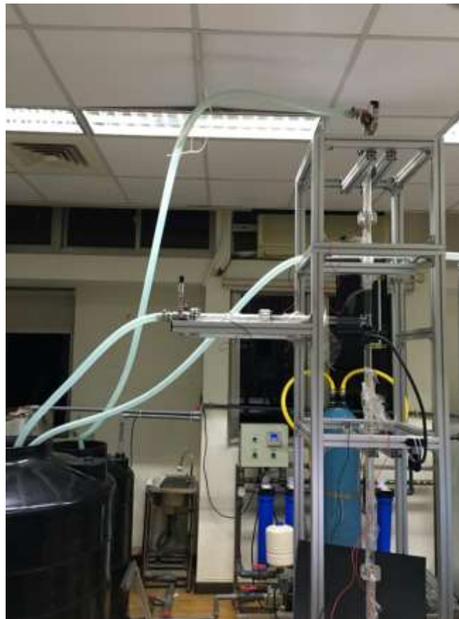
圖 3.1.5.4 T 型管氣水分離之實驗模組
