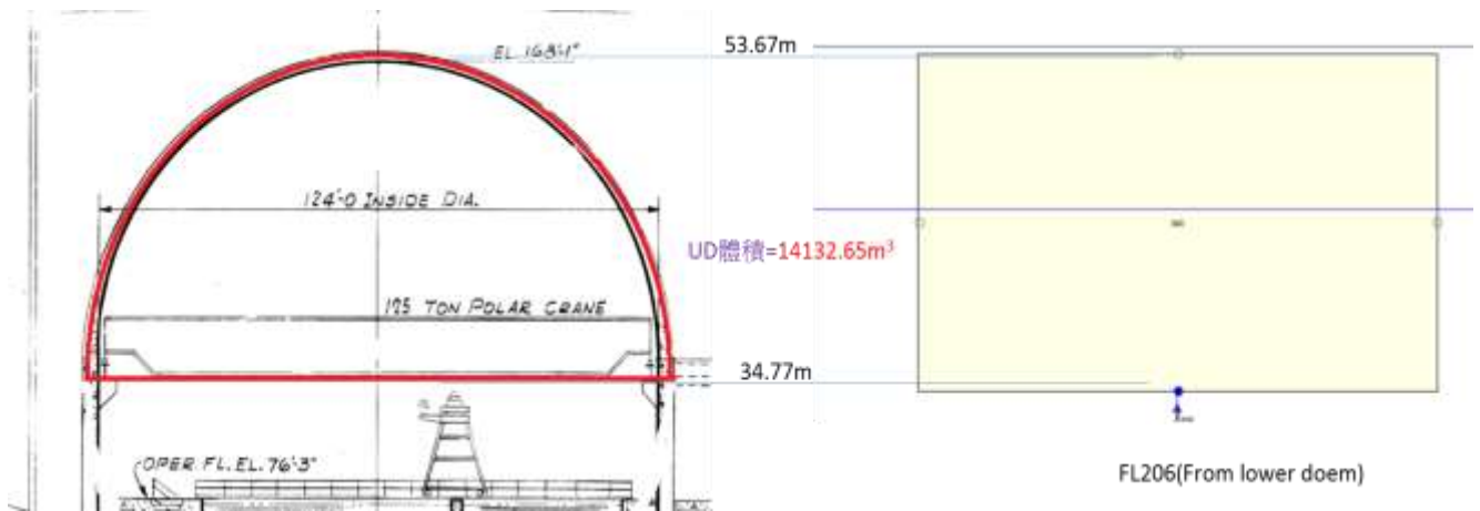
圖 3.2.10 上圓頂幾何與 MELCOR 模型比對示意圖
