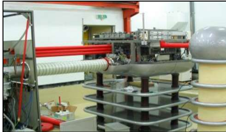
圖 3.4.3.1 高能離子佈植機(High Voltage Ion implanter)
