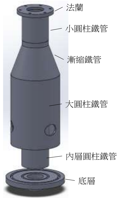
圖 3.4.2.22 Mixing chamber 各部分外觀構造圖
