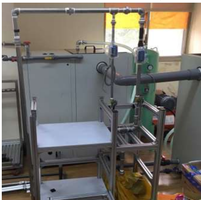
圖 3.1.5.13 電子式液體流量計
