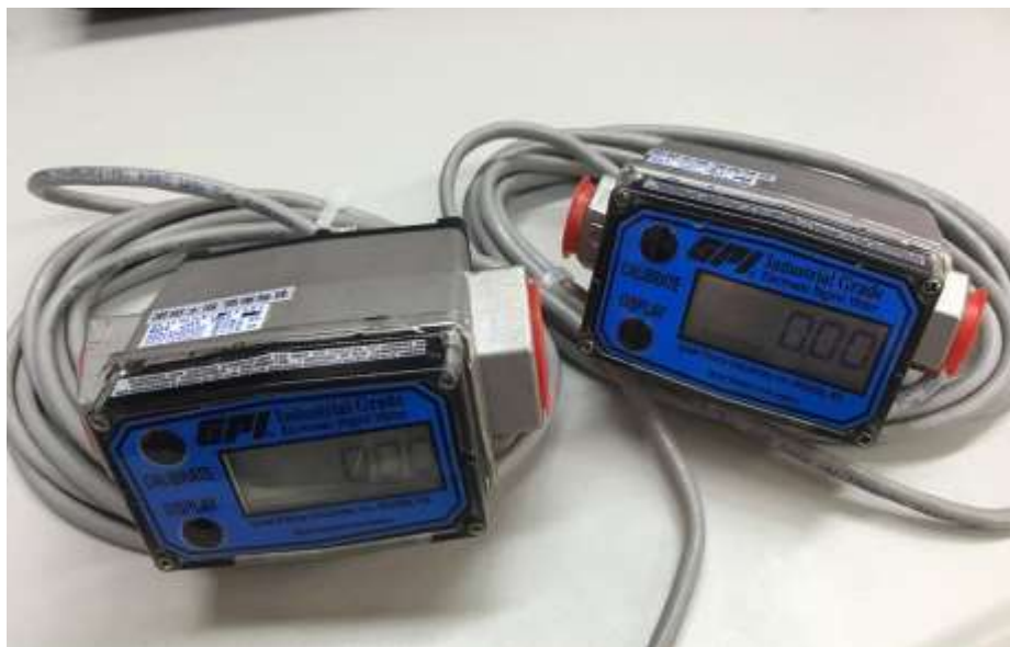
圖 3.1.5.10 電子式液體流量計
