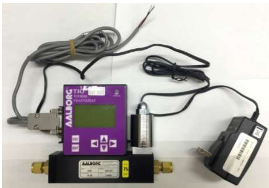
圖 3.1.5.11 電子式氣體流量計
