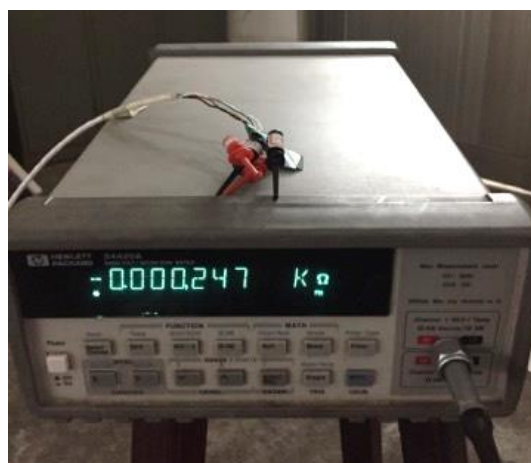
圖十五、本實驗使用之電性量測儀 Hewlett-Packard 34420A
