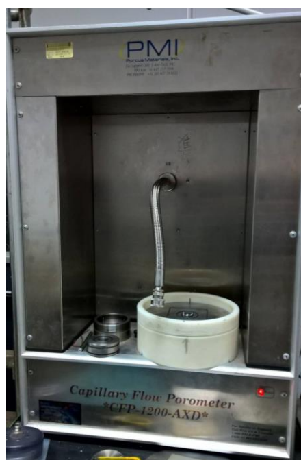
圖十三、本實驗使用之通氣率量測儀器 PMI capillary flow porometer
