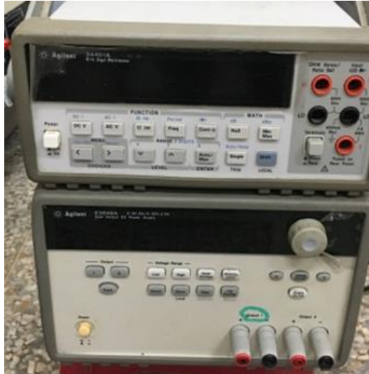
圖十七、Agilent E3648A Dual Output DC Power Supply 電源供應器 (下)及 Agilent 34401A 6.5 Digit Multimeter 萬用電錶(上)
