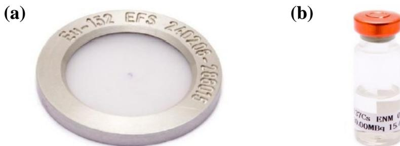
圖 4. 射源幾何型態。(a)圓盤型、(b)試瓶膠體型。
