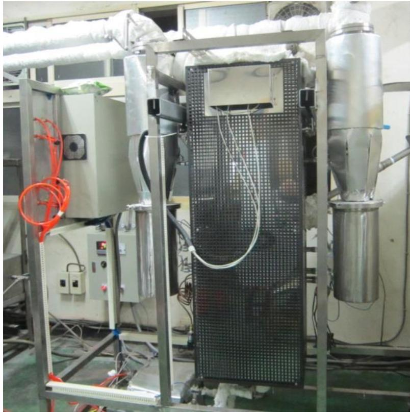
圖 2.2 20 kW<sub>th</sub> 內通式流體化床氣化爐實體構造
