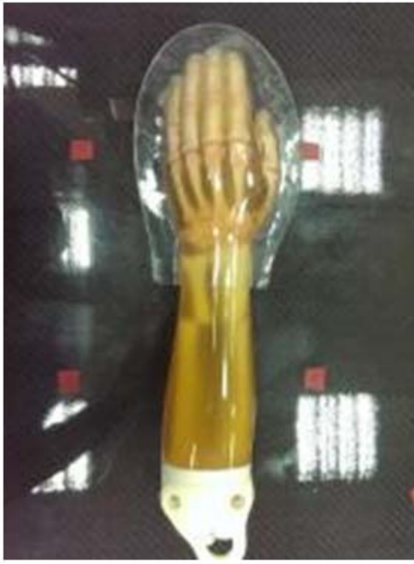
圖五、製作之骨折假體之外觀。
