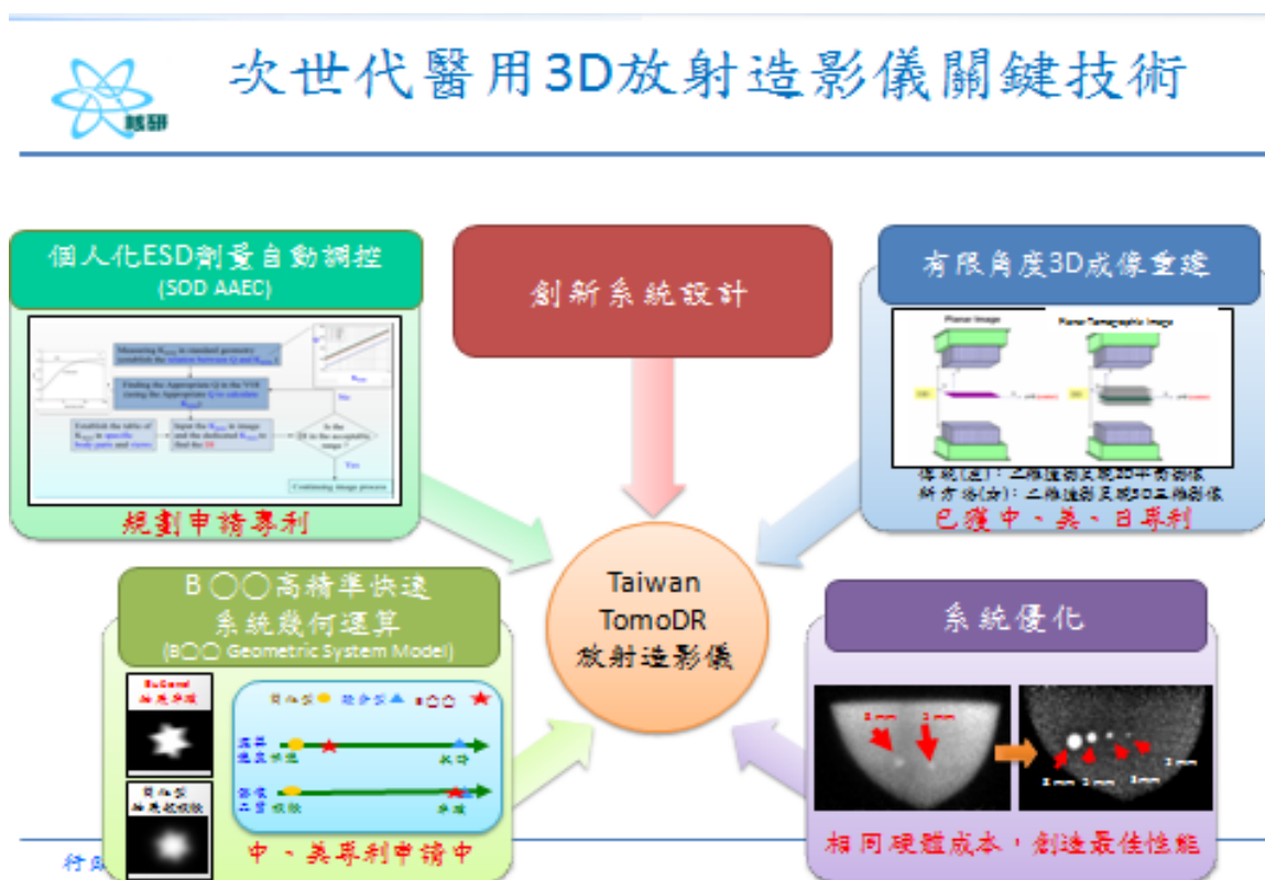
圖一、醫用 3D 放射造影儀之系統設計及概念。
