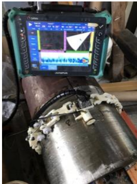
圖 3-64 銲接管件之陣列超音波檢測進行方式及探頭架設外觀。
