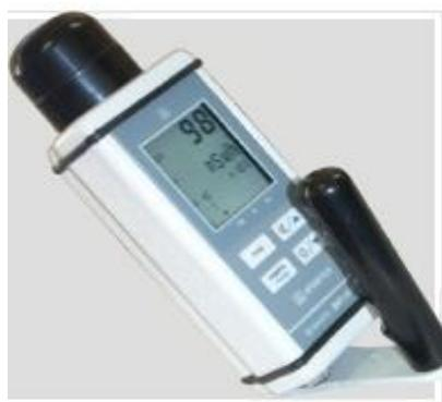
圖 1. 手持式偵檢器：ATOMTEX AT1121 塑膠閃爍偵檢器
