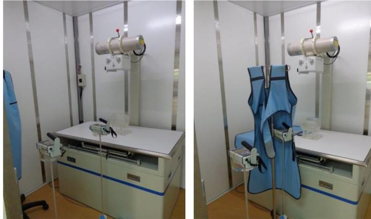
圖6. 考量動物用X光機協助者在檢查室內協助動物擺位照相的情形，以手持式偵檢器測量，評估其有穿(右)及無穿(右)鉛屏蔽衣之居估位置劑量(率)示意圖
