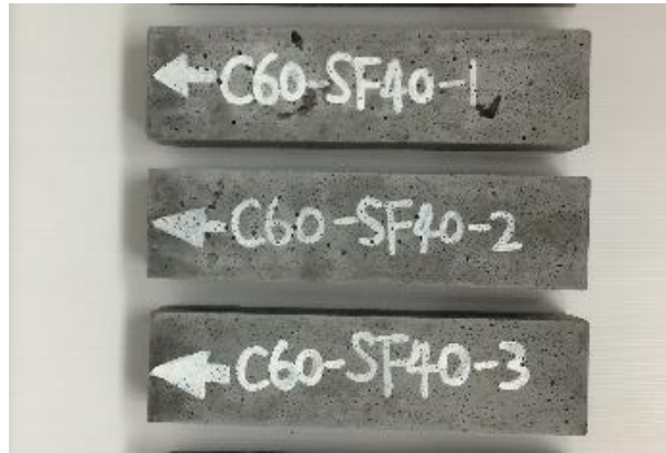
圖 4.53 B200-C60-SF40 角柱乾縮試驗前
