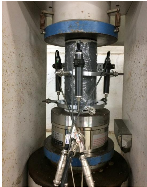
圖 3.22 荷重、變位實驗設置
