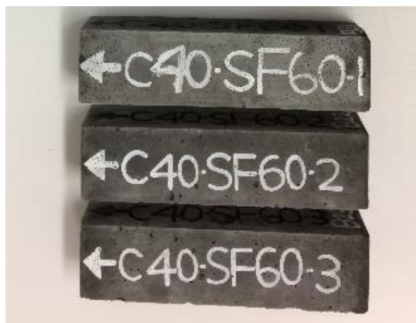
圖 4.55 B200-C40-SF60 角柱乾縮試驗前
