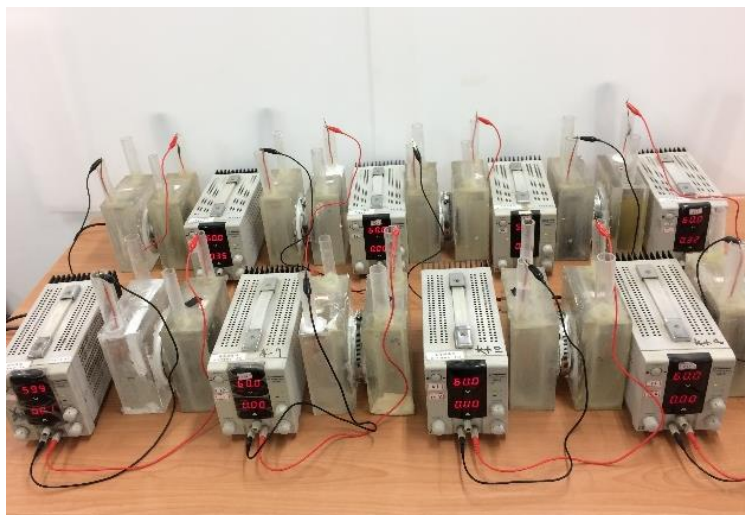
圖 3.24 RCPT 試驗情形
