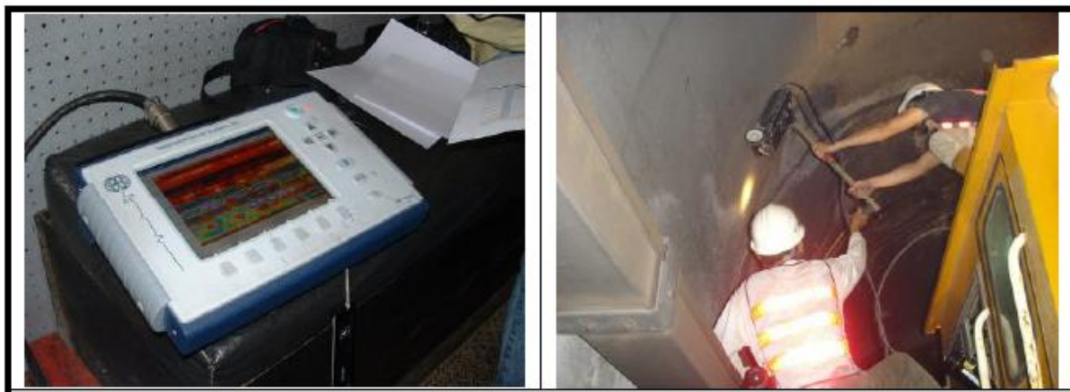
圖3.2-8 GPR主機及現場施測照片(交通部台灣鐵路管理局，2008)
