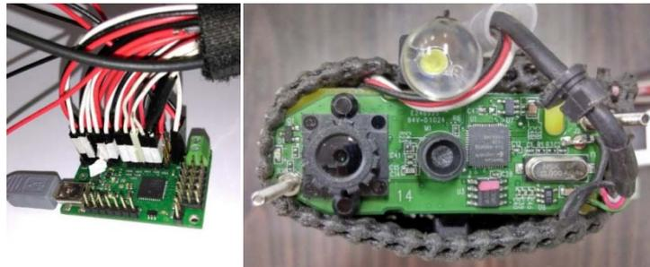
(a)馬達控制板硬體配置 (b)攝影鏡頭模組與 LED 硬體配置
