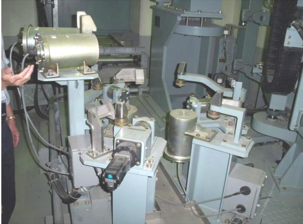
圖 7.2.6-2、WDIS 廢棄物桶表面劑量率度量與表面污染擦拭總  $\alpha$  量測單元
