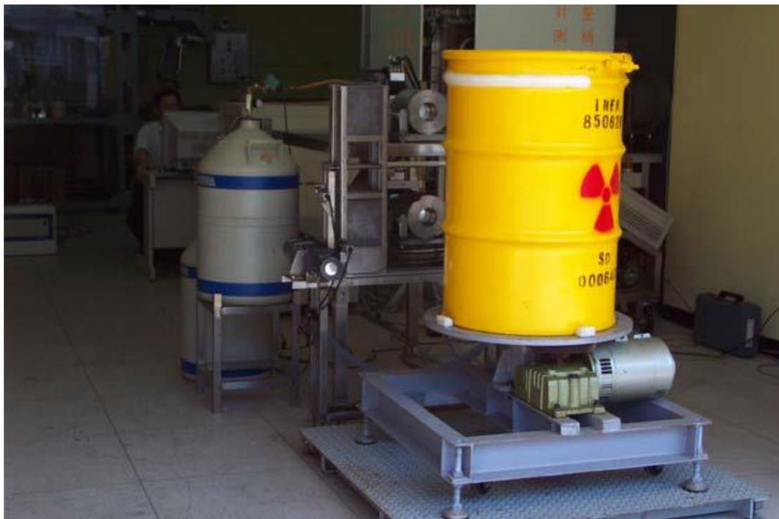
圖 7.2.5-1、核研所加馬核種整桶量測系統
