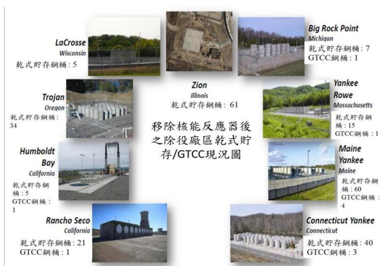
圖 一、九個美國除役廠乾式貯存與 GTCC 之鋼桶數量
