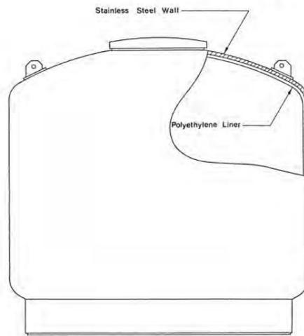
圖 18 LN Technology 的 PE 內襯，外層不鏽鋼加強的複合結構 HIC。[32]
