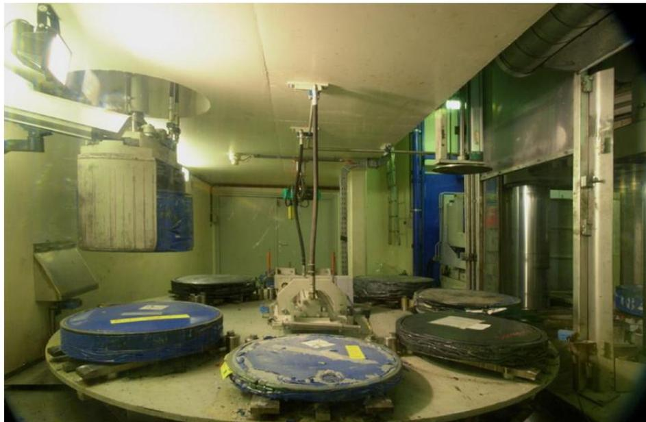
圖 三十五、BELGOPROCESS 超高壓壓縮機
