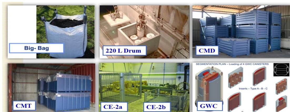
圖 十八、Zorita 核能電廠裝載容器實際照片
